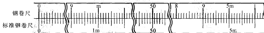
图 3 标准钢卷尺与钢卷尺的线纹方向
